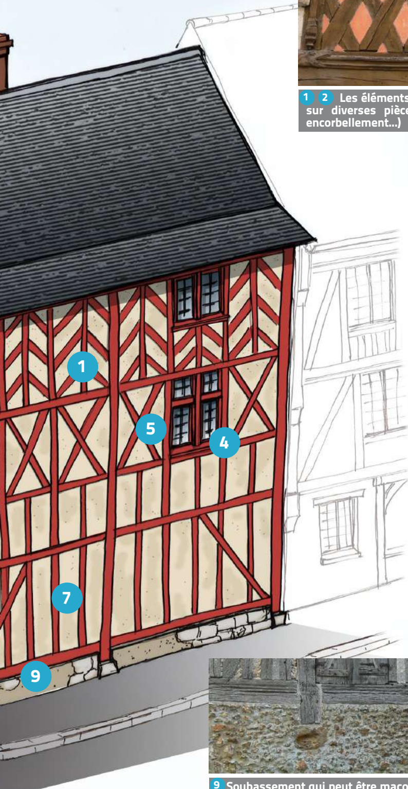
9 Soubassement qui peut être maçonné avec divers matériaux (briques, pierres, moellons, silex)
